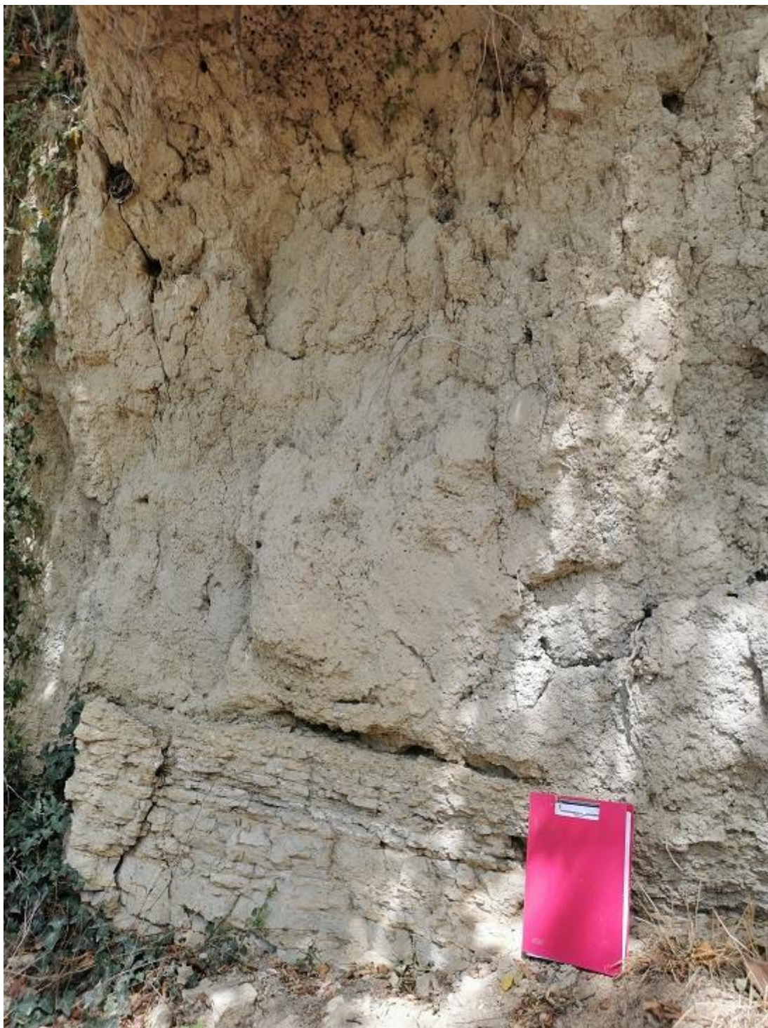
Figura 5 Particolare del contatto tra le coperture colluviali ed il substrato pelitico-arenaceo.
